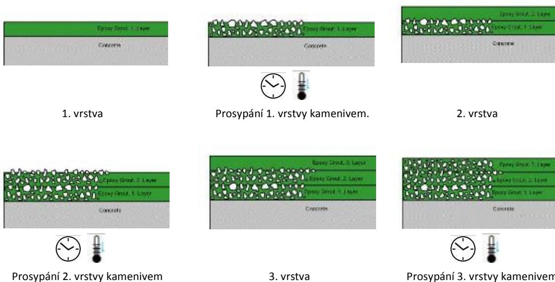
Udržujte povrch jednotlivých vrstev zcela čistý (bez prachu, vody apod.).
