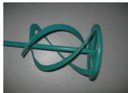
Toto míchadlo je nevhodnější pro míchání směsi komponentů A a B s komponentem C
