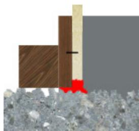
Dřevěné bednění musí být důkladně utěsněno k podkladu pomocí pružného tmelu, např. Sikaflex®-11 FC+.
