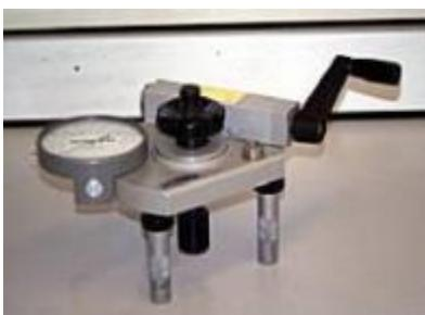
V případě pochybností ohledně pevnosti podkladu provedte zkoušku přídržnosti povrchových vrstev (jak je uvedeno na obrázku vlevo).
