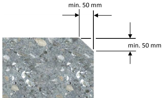
Před aplikací Sikadur®-42 je nutné zkosit rohy betonového podkladu.
