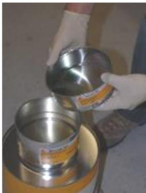
Komponent B (tvrdidlo) nalijte do komponentu A (pryskyřice).
