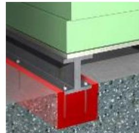
Otvory a kapsy pro kotevní šrouby musí být zcela čisté a mohou být vyplňeny samonivelačním tekutým tmelem řady Sikaflex®. Kotevní šrouby by měly být obaleny pružnou izolační páskou tloušťky cca 6 mm, aby se zabránilo přilnutí zálivkové malty na kotevní šroub. Izolační páska by měla dosahovat z horní části betonového podkladu na spodní stranu základové desky stroje.
