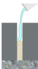
Výplň spár zhotovených z polystyrenu lze odstranit pomocí rozpouštědla, např. Sika® Colma Cleaner apod.
