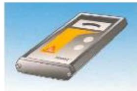
Dielektrické vlastnosti materiálu, vycházející z obsahu vody, také umožňují nedestruktivní měření s elektrodou přitisknutou na povrch potěru. Ke stanovení údajů ohledně připravenosti potěru pro následnou aplikaci jsou velmi užitečné měřicí přístroje jako „Tramex“, protože rychle a jednoduše udávají, zda naměřený obsah vlhkosti znamená, že obsáhlé CM měření lze očekávat jako úspěšné.
