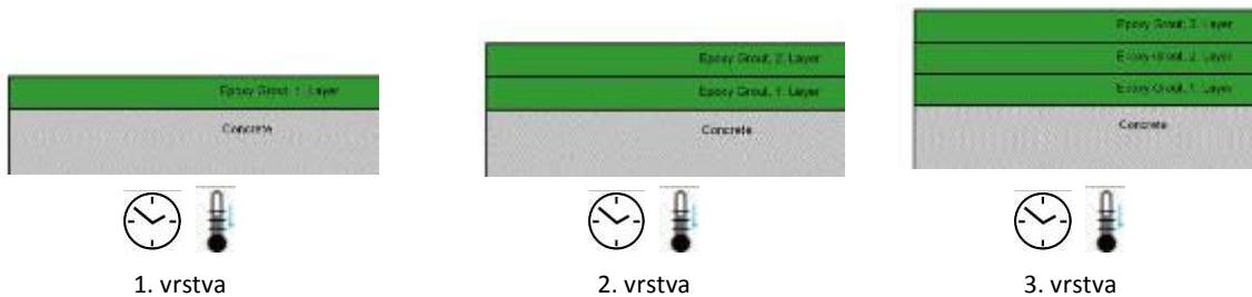
Udržujte povrch jednotlivých vrstev zcela čistý (bez prachu, vody apod.).
