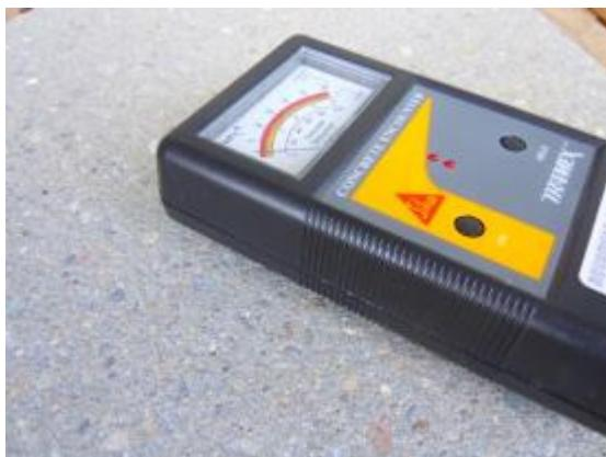
Použití přístroje Tramex pro měření vlhkosti podkladu
