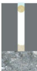
Po roztavení (odstranění pomocí rozpouštědla) polystyrenu je nutné aplikovat pružný tmel na dno spáry. Na horním konci je nutné instalovat pružný tmel s výplňovým provazcem.
