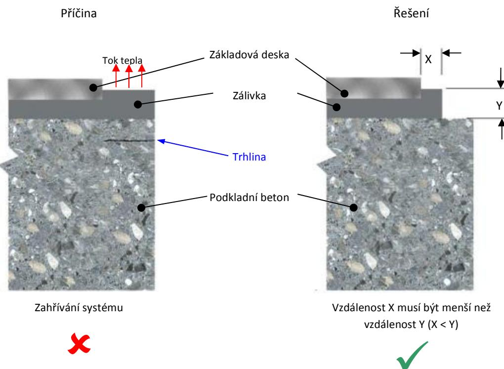
Doporučuje se, aby velikost otevřeného povrchu epoxidové malty od hrany základové desky (X) byla menší nebo rovna tloušťce vrstvy aplikované epoxidové malty. Tím se odstraní problém s vlněním okrajů.
