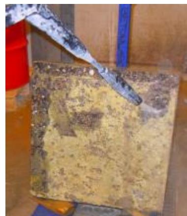
Zbytky retardačního (zpomalujícího) prostředku musí být z betonu odstraněny pomocí tlaku vody...
