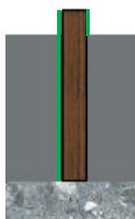
Gumová páska (zelená) může být použita pro zabránění přilnutí licí malty k bednění (zejména na porézní materiály jako je dřevo). Tím se zajistí snadné odstranění bednění.
